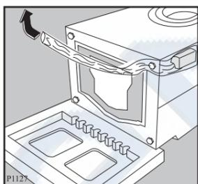
5. Поставьте машину в вертикальное положение и удалите оставшийся болт с задней панели. Вытащите соответствующую пластиковую шпильку.
